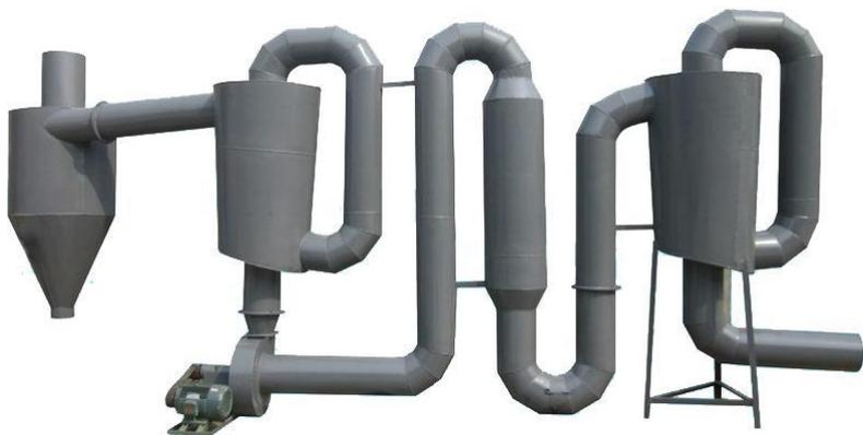
Сушка опила производится в при помощи горячего воздуха. Нагрев осуществляется при помощи печи, работающей на твердом топливе.
